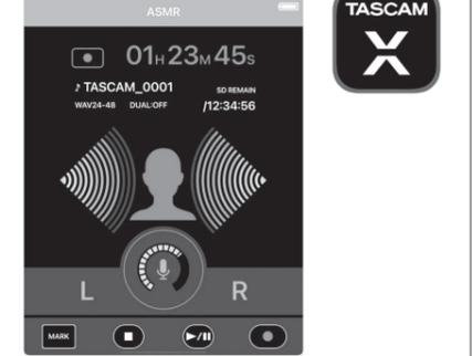
スマートフォンやタブレット上でPortacapture X8をワイヤレス操作できるアプリで、本体の設置場所にとられない柔軟な運用が可能。録音や停止といった基本動作だけでなく、ゲイン調整やミキサー操作、マーク登録など本体で行える全ての操作をコントロールできます。
