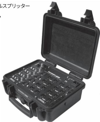
マイク/ライン信号に対応したシグナルスプリッター。1入力/4出力のストリップを4系統搭載し、最大1入力/16出力まで対応。GT LINE社の強靱なハードケースにマウント。長距離伝送用トランス出力モデルもラインナップしています。(受注生産)
